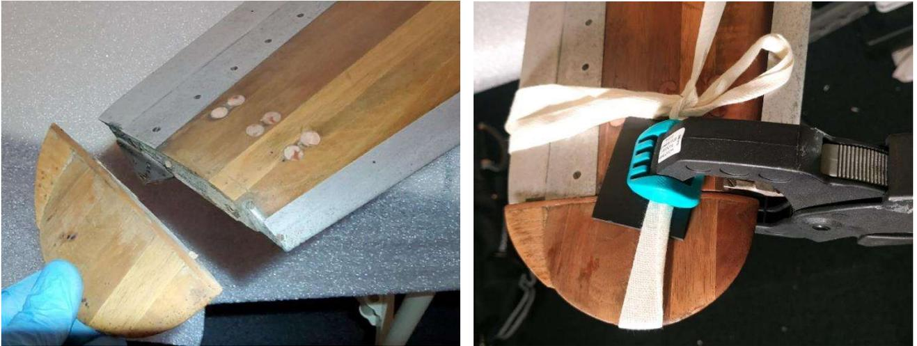
*Fixage de l'extrémité d'une aile brisée*
